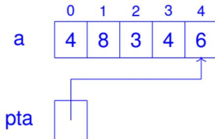
**Pas på!** C ser ikke efter om et indeks man forsøger at tilgå ligger indenfor arrayets grænser:
